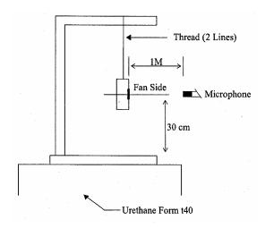
1 METER FROM MICROPHONE TO FAN INTAKE
