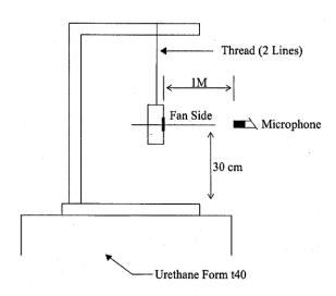
1 METER FROM MICROPHONE TO FAN INTAKE
