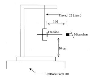
1 METER FROM MICROPHONE TO FAN INTAKE
