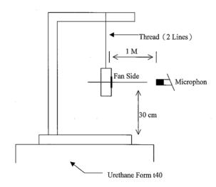
1 METER FROM MICROPHONE TO FAN INTAKE
